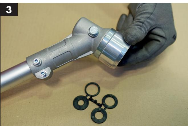
Montare la ghiera sulla coppia conica usando, se necessario, una delle rondelle di centraggio incluse.
