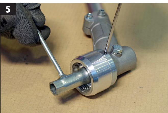
Serrare saldamente il dado/vite usando la chiave del decespugliatore.
