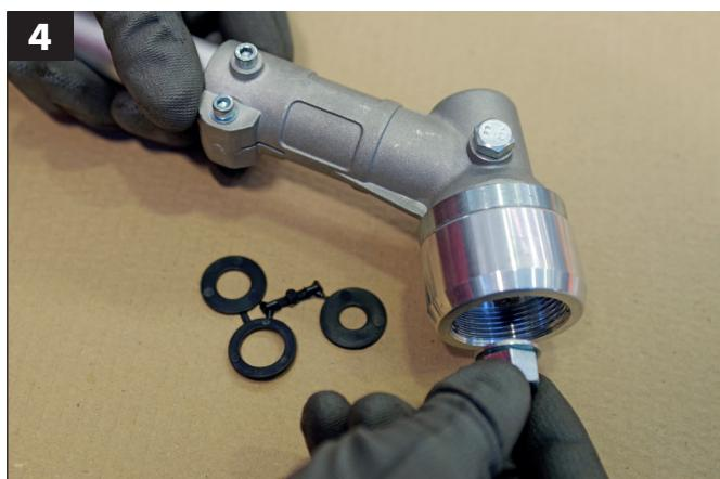
Avvitare il dado/vite di fissaggio del proprio decespugliatore sul perno filettato della coppia conica.
